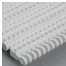
50-300 Superficie de malla ligeramente abierta para drenaje. Levanta el producto y minimiza el contacto.
